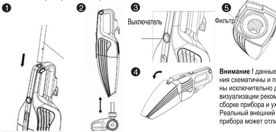
**Внимание!** данные изображения схематичны и предназначены исключительно для визуализации рекомендаций по сборке прибора и уходу за ним. Реальный внешний вид прибора может отличаться.
